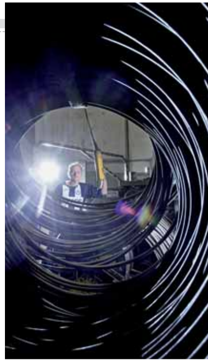
Aus dick mach dünn: Karl-Heinz Theiler zieht Draht in die Länge – für einen Kunden, der daraus Schrauben macht.
